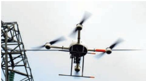
◀ *RTE est devenu opérateur de drones en 2016. Ces appareils permettent de diminuer la pénibilité de certaines interventions sur des lignes difficiles d'accès ainsi qu'un gain de temps sur des opérations de maintenance et surveillance du réseau, sans interrompre l'alimentation électrique.*
