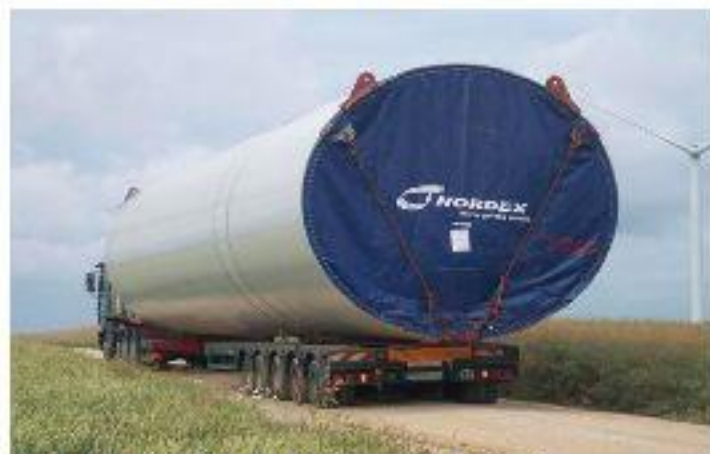
Mât 80 mètres en 4 tronçons
